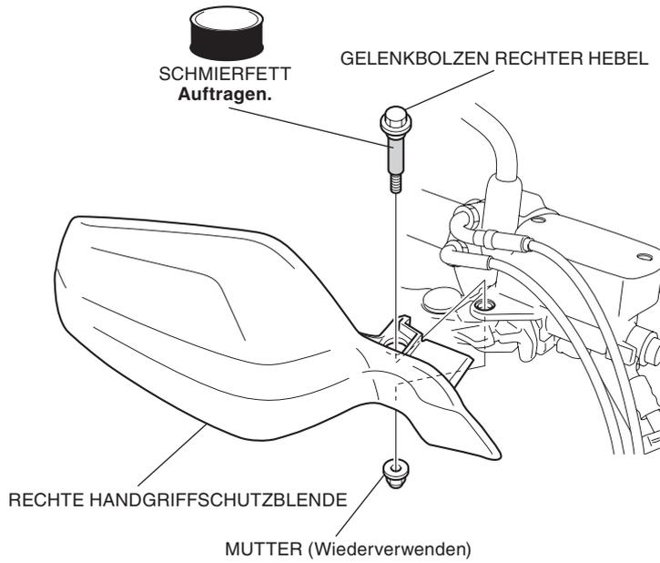
13. Positionieren Sie die Gaszüge und ziehen Sie die Muttern fest an.
