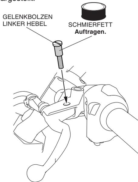
4. Entfernen Sie die Schraube, wie in der Abbildung dargestellt.
