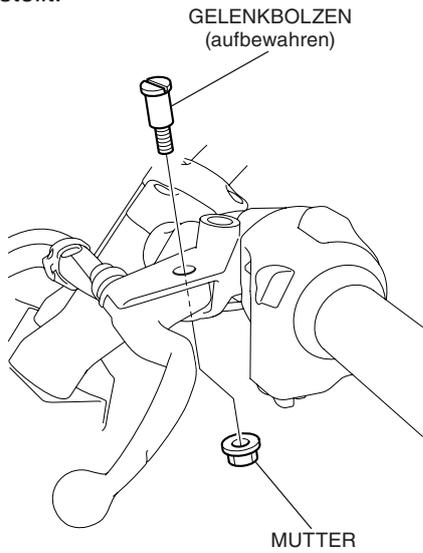
3. Montieren Sie den Gelenkbolzen des linken Hebels wie dargestellt.
