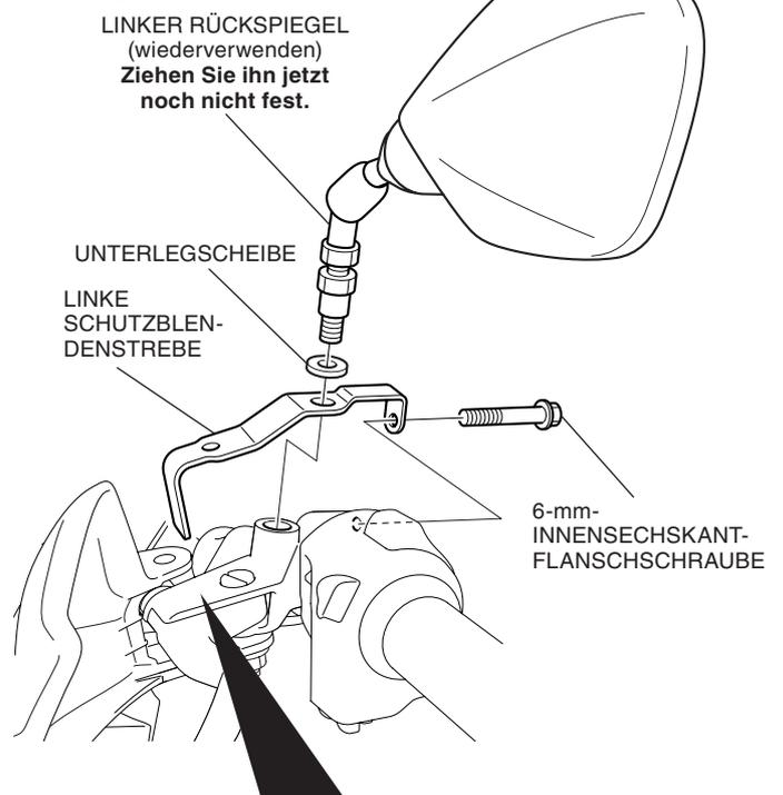
**Montieren Sie die linke Schutzblendenstrebe unter der linken Handgriffschutzblende.**
