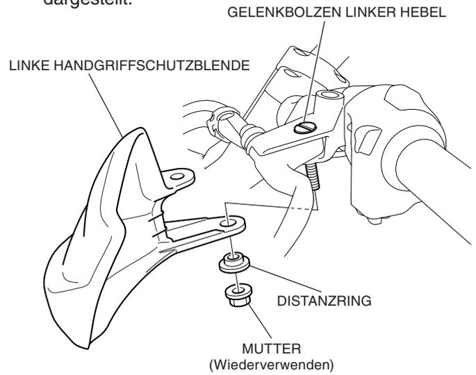
6. Montieren Sie die linke Schutzblendenstrebe und den linken Rückspiegel wie in der Abbildung dargestellt lose.
