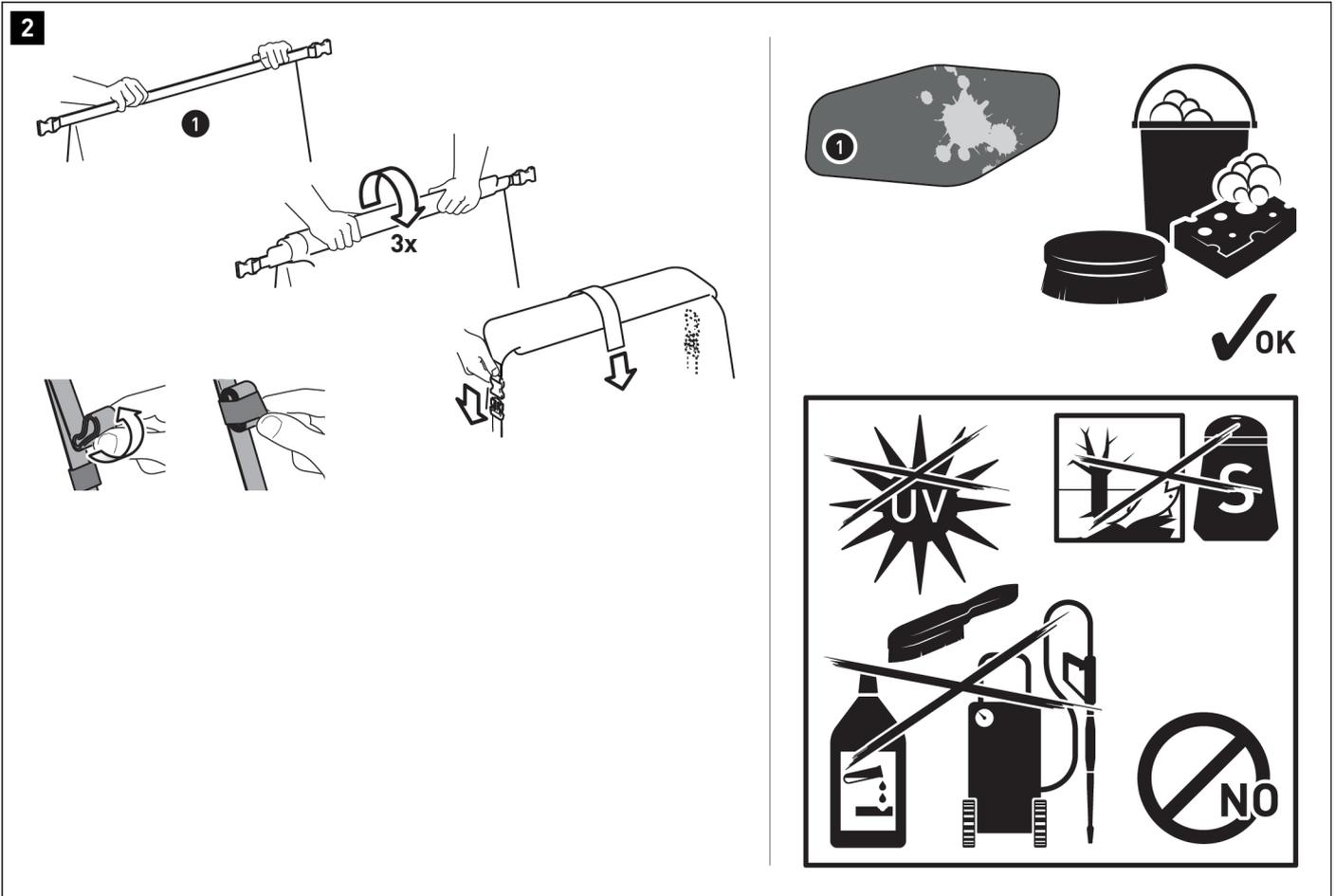
Verschließen Sie die Hecktasche (1) wie gezeigt; rollen Sie dazu die Öffnung dreimal ein und verschließen Sie diese mit den Steckschnallen. Rollen Sie die Überlängen der Steckschnallengurte auf und fixieren Sie diese mit den elastischen Schlaufen.
